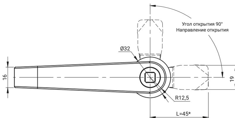
Замок с механизмом блокировки поворота ручки на основе торсионной пружины (поворот ручки возможен только после поворота ключа, после извлечения ключа замок автоматически возвращается в исходное закрытое положение).
