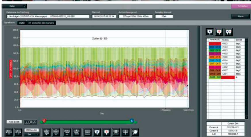
fot. 12. Wykres z wielokanałowego rejestratora temperatury pod- czas badania trzech rozłączników z zaciskami piętrowymi typu V (z nową przekładką). Cykle od nr 501 do 750.
