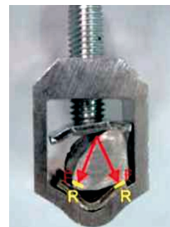
fot. 7. Znaczne zmniejszenie powierzchni styku w wyniku błędnego montażu
